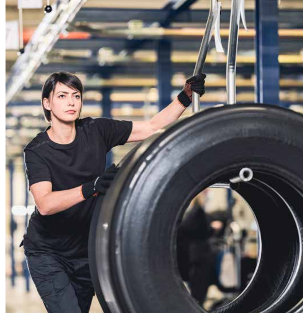
Zowel de vernieuwde band als het productieproces moet voldoen aan het Europese keurmerk UN-ECE-R109.
